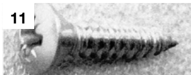
11 Schraube FZ ST 6.3 x 25 A4 DIN 7682 C
